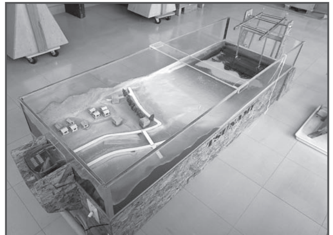
平野から谷間に向かって波が押し寄せる様子がわかる「津波実験装置」
