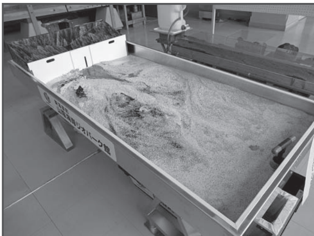
谷間から流れ出るときにできる扇状地やそれを削る川の作用、水がさまざまな色の砂を運ぶ様子、運ばれた砂が水中に積もる様子がわかる「砂の流動実験装置」
