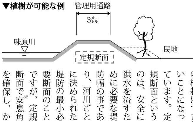
の植栽はできないことになっています。定規断面というのは、安全に洪水を流すために必要な堤防幅の事であり、河川ごとに決められた堤防の最小必要断面のことですが、定規断面で安息角を確保し、か
